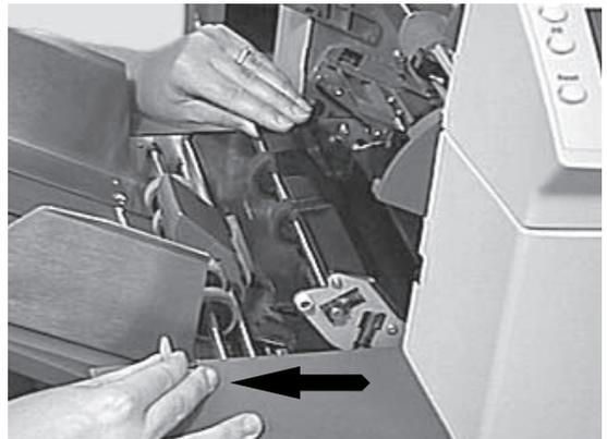
**Hinweis:** Der Zugang zu diesem Bereich kann durch die Entfernung der Falztasche 1 und des Blatteinzugs 2 weiter verbessert werden.
