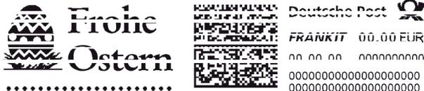
Das Bild oben zeigt schlechte Drucke mit fehlenden Linien. Dabei handelt es sich um eine Schwarzweißdarstellung der zugelassenen blauen Freimachungsvermerke. Es sollte nur zugelassene blaue Tinte in diesem Gerät verwendet werden.
